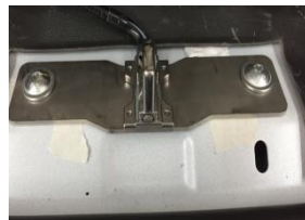
1.3 根据锁扣组箭头朝向正确安装，用原车螺母把垫板平行拧紧，注意居中安装
