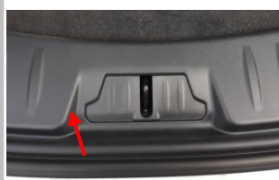
1.1 使用撬板把原车后踏盖拆下
